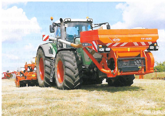
L'utilisation d'outils frontaux est une piste pour assurer un lestage « productif ». Ils peuvent même, dans le cas de trémies ou de cuves, limiter la capacité de relevage nécessaire à l'arrière.
