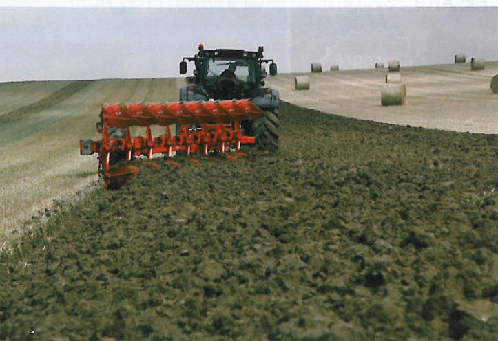
Malgré la prépondérance du chariot dans l'hexagone, les charrues monoroue séduisent grâce notamment à un report de charge plus important.
