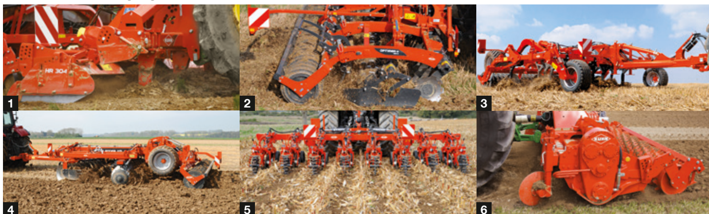
1. Décompacteurs - 2. Déchaumeurs à disques - 3. Déchaumeurs à dents - 4. Déchaumeurs à disques type cover crop - 5. Strip-till - 6. Fraises rotatives
