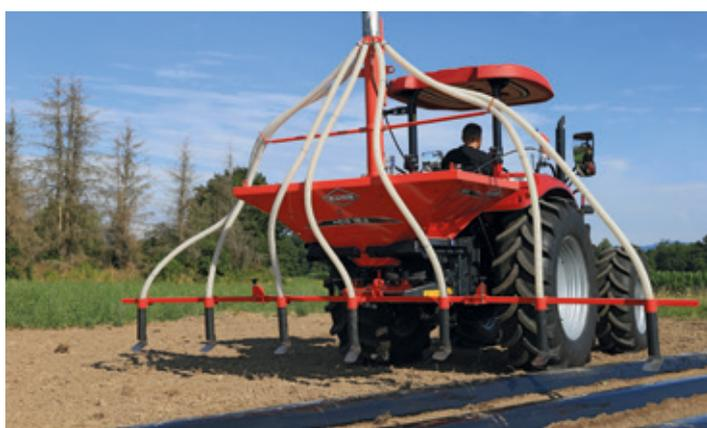
Le distributeur MDS .2 peut être équipé facultativement d'un localisateur à tubes spécialement conçu pour les cultures en rangs comme le maïs, les fraises, les légumes, etc. L'apport d'engrais souhaité s'opère avec précision simultanément sur sept rangs au maximum.
