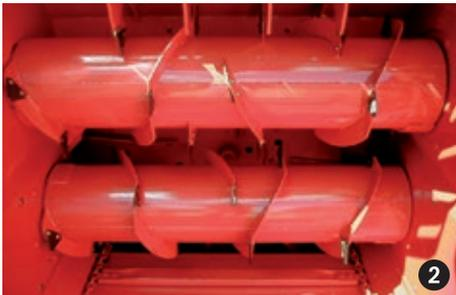
Quant aux modèles ALTOR 6070 et ATHENOR 6070, ces derniers accueillent deux démêleurs (2) justifiés techniquement par une hauteur de caisse plus importante. Equipés également de sections, ces deux démêleurs sont associés à 5 peignes régulateurs escamotables hydrauliquement.
