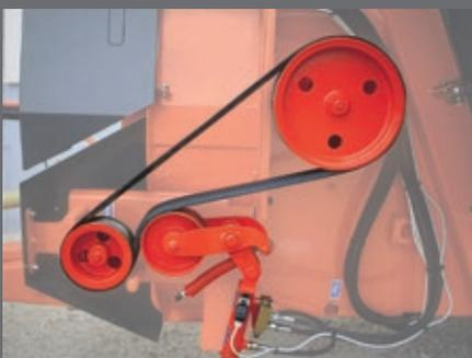
L'entraînement POLYDRIVE du démêleur est une transmission à courroie débrayable hydrauliquement qui offre de nombreux avantages :
