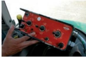
Changement de vitesse de la turbine (270/540 min<sup>-1</sup>) par un téléflexible.
