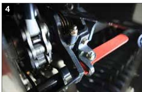
Débrayage mécanique du rotor
