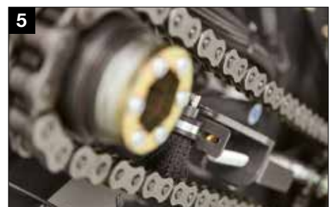
Brosses de lubrification larges et solides sur les chaînes, pour une lubrification optimale
