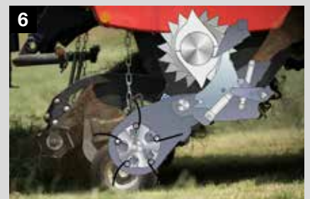
6 Une fois la trappe DROPFLOOR revenue en position, ce sont les couteaux qui reprennent leur place. Le fait de dissocier le déplacement de la trappe et des couteaux assure un processus rapide et sûr
