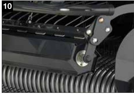
Rouleau tasse andains de gros diamètre (Ø 217 mm)
