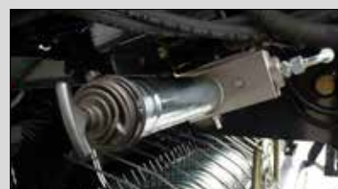
Système de graissage des roulements Beka Max
