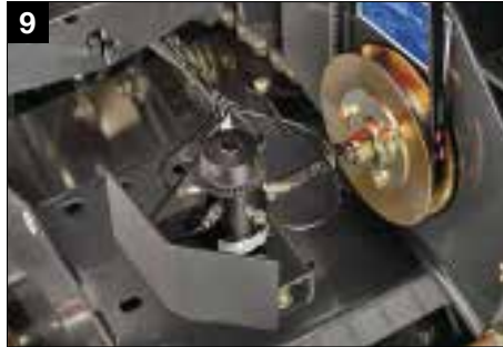
Lubrification des chaînes automatique en continu BEKA-MAX
