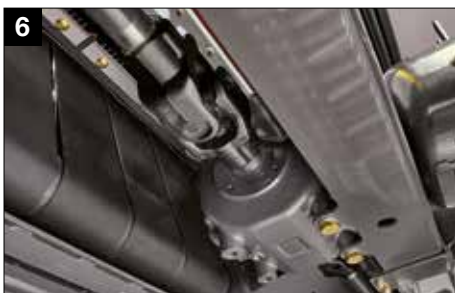
Arbres d'entraînement avec joints de cardan intégrés
