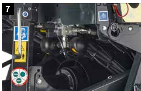
Vanne proportionnelle pour un contrôle de la densité en cabine de série
