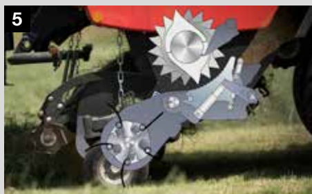
5 Une fois que le rotor atteint une vitesse adéquate, la trappe DROPFLOOR est ramenée en position. Grâce au processus automatique, le temps consacré à l'opération est réduit au strict minimum
