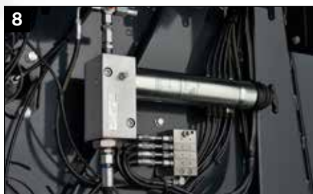
Système de graissage automatique des roulements de série
