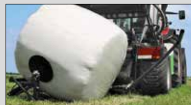
Dépose balle vertical pour que la balle se retrouve sur sa partie plate
