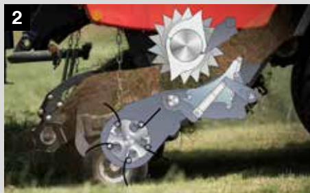
2 Une fois la prise de force débrayée, la presse lance automatiquement la séquence de déblocage. Les couteaux commencent par se rétracter, suivis par l'abaissement de la trappe DROPFLOOR
