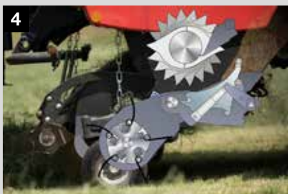
4 La vitesse du rotor est constamment surveillée pendant tout le processus. Le mouvement du rotor indique le moment où le système d'alimentation est débloqué, ce qui déclenche l'étape suivante du processus
