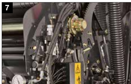
Valve proportionnelle pour un contrôle de la densité en cabine
