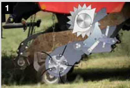
1 En cas de blocage de l'alimentation, un signal sonore et visuel sur le terminal de commande informe l'opérateur. L'alimentation est protégée par une protection automatique par embrayage à came sur l'entraînement principal
