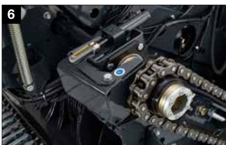
Débrayage hydraulique du rotor de série
