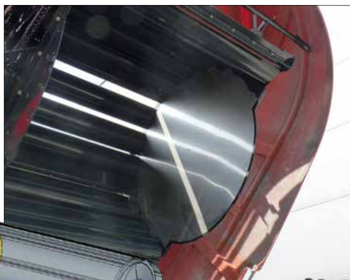
Plaques intégrées en acier inoxydable à faible friction
