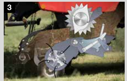
3 Une fois les couteaux et la trappe DROPFLOOR abaissés, l'opérateur peut embrayer la prise de force de la machine. Grâce à la trappe DROPFLOOR abaissée, le fourrage agglutiné peut être inséré dans la machine
