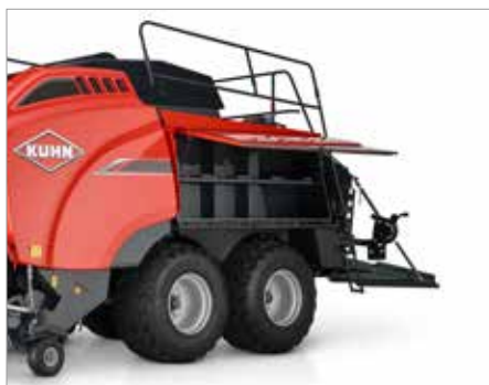
7. Compartiments à ficelle très accessibles de capacité 2 x 16
