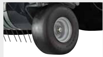
Roues de jauge de pick-up pivotantes semi-pneumatiques
