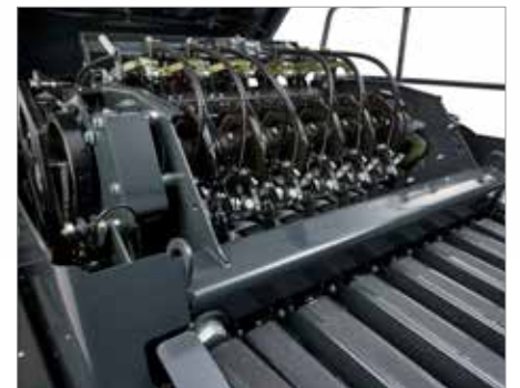
4. Nœud double nœud avec surveillance électronique de série
