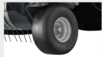
Roues de jauge de pick-up pivotantes semi-pneumatiques
