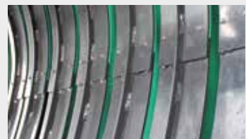
Plaques Téflon facilitant le flux pour la chambre de pré-compression
